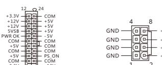
O conector ATX PWR12V (8 pinos) fornece principalmente uma tensão de reforço para a CPU e a placa de vídeo.
